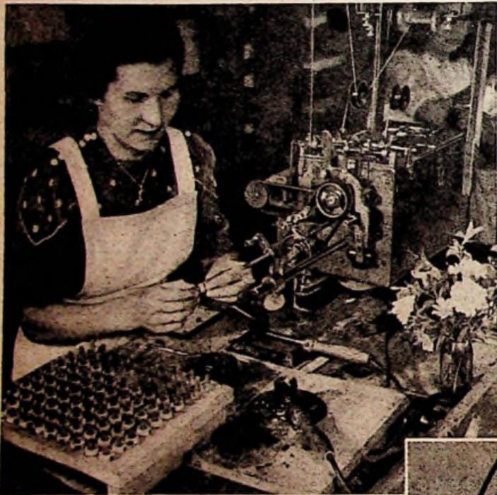
An der Arbeitsschablone werden nach dem Wickeln die Drahtenden der Kreuzwickelspule gekürzt
